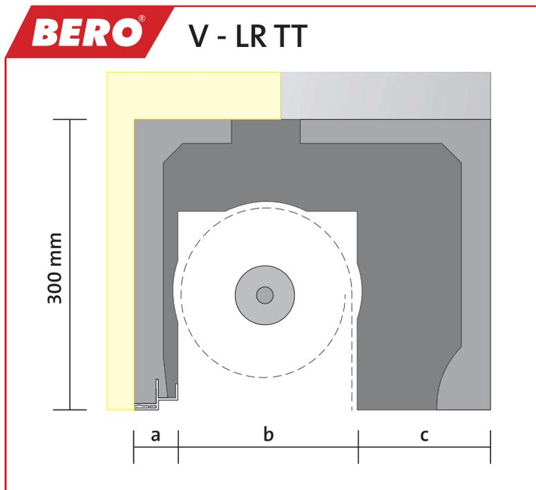
Selbsttragender Rollladenkasten aus bewehrtem BEROPor-Leichtbeton für ein Mauerwerk mit Wärmedämm-Verbundsystem und einer **äußeren Montageöffnung** für einen linksrollenden Rollladen. Optimierte Innendämmung und thermische Trennung aus BERO® Porozell (WLS031), Kunststoffabschlussprofil außen inklusive Putzeinsteckschiene, gedämmte Kopfteile mit Stehbolzen zur Montage der Lagerhalter.
